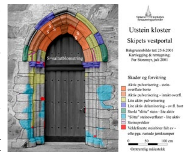
Figur 31. Kart over skadene på skipets vestportal på Utstein kloster. Map of weathering phenomena at the west portal of the nave at the monastery of Utstein near Stavanger.
