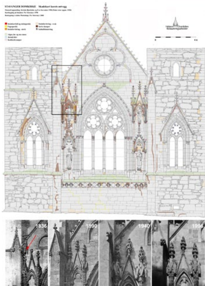
Figur 29. Østveggen på Stavanger Domkirke. Kart over skader og utvikling av sorte skorper. Litografi 1836: Schiertz/Müller. Foto: 1890 C. Jacobsen, 1940 G. Fischer (1964), 1996 P. Storemyr. Legg merke til at vann ble drenert rett ned på nisjene tidligere. Map of weathering phenomena at the east façade of Stavanger cathedral.
