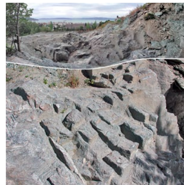
Figur 23. Bakkaune kleberbrudd etter utgraving, før bygging av boligblokk: Over: Med utsikt mot Trondheimsfjorden. Under: Uthugde blokker ferdige til å kiles ut. Fotos: P.Storemyr. / Bakkaune soapstone quarry after excavation and before building commenced.
