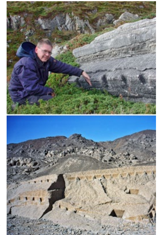
Figur 34. Allmenningen marmorbrudd: Over: Store kilehull fra middelalderen. Under: Romerske kilespor i bruddene i Mons Claudianus i den egyptiske østørkenen. Fotos: P.Storemyr. Allmenningen marmorbrudd: Large medieval wedge holes. Roman wedge holes in Mons Claudianus inne the Eastern Desert of Egypt.
