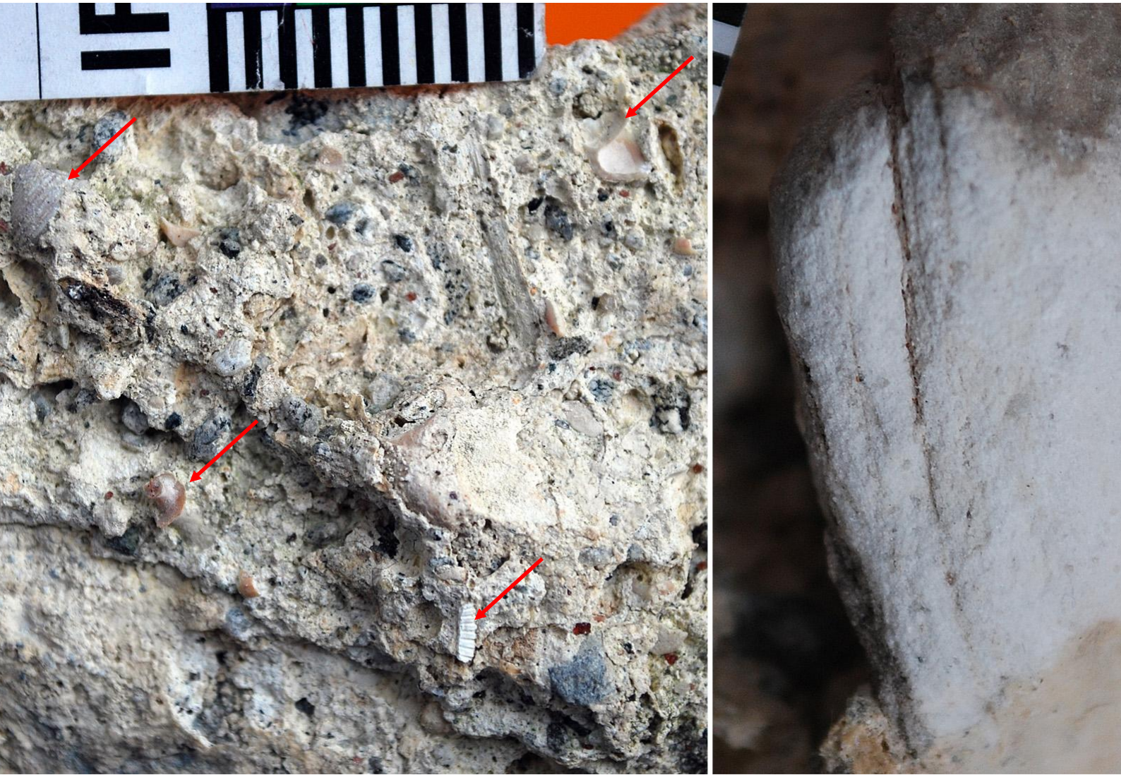
Figur 37: Mørtel fra klosteret med skjellsand (piler viser skjellfragmenter). Det høyre bildet viser en brent marmorbit fra muren på skipets nordside.
