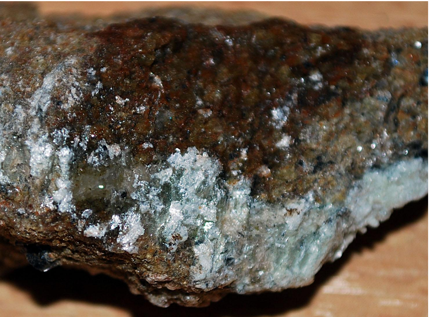
Figur 26: "Dråpetesten" på en liten bit olivinstein: På den lyse talk/magnesitt åren blir dråpen stående lenge, på de gulbrune olivinpartiene suges den opp umiddelbart. Sistnevnte er altså vesentlig mer porøs.
