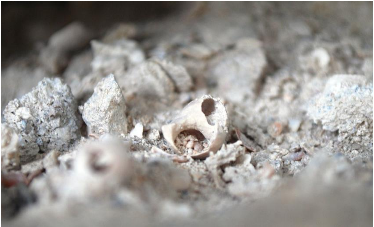
For å bygge Kinn kirke brant man skjell til bruk i mørtel i middelalderen. Her fra en fuge der mørtelen har skjellsand i tilslaget. Foto: Per Storemyr
