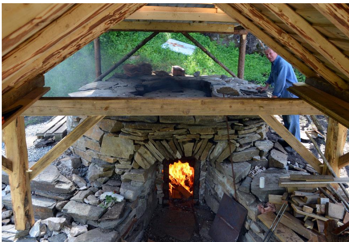
Eksperimentell kalkbrenning i en nedskalert, fri kopi av en middelalderovn, Kvernsteinsparken i Hyllestad. I denne ovnen når man mer enn 1200 grader i bakkant og bare 7-800 grader i framkant. Foto: Per Storemyr.
