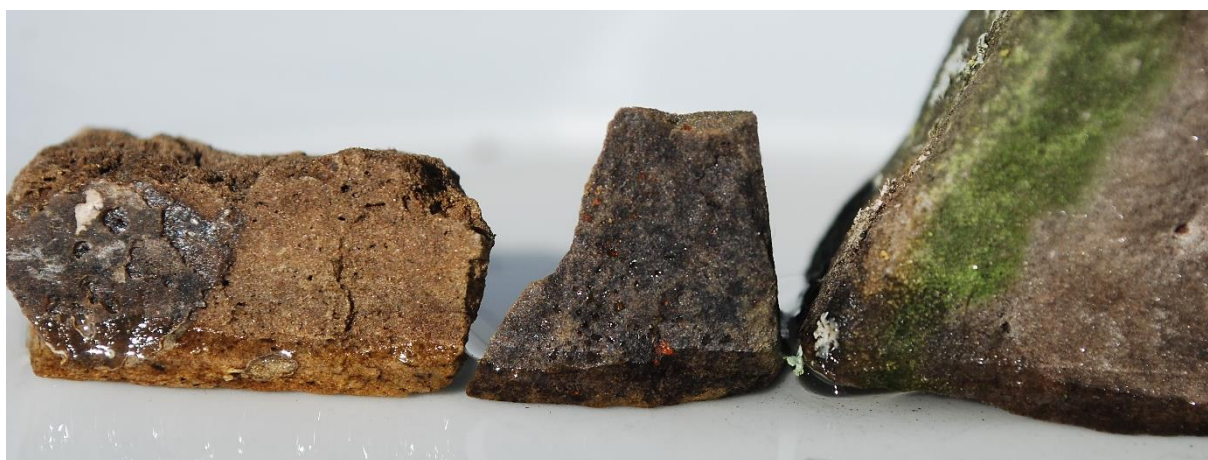
Figur 55: Test av kapillær oppsuging av prøver fra Hoppestad 2, Ås 4 og Nordbø. Etter 12 timer med «foten» i vann har det skjedd svært lite, kun i den ene enden av den høyre steinen er det noe kapillær stigning.
