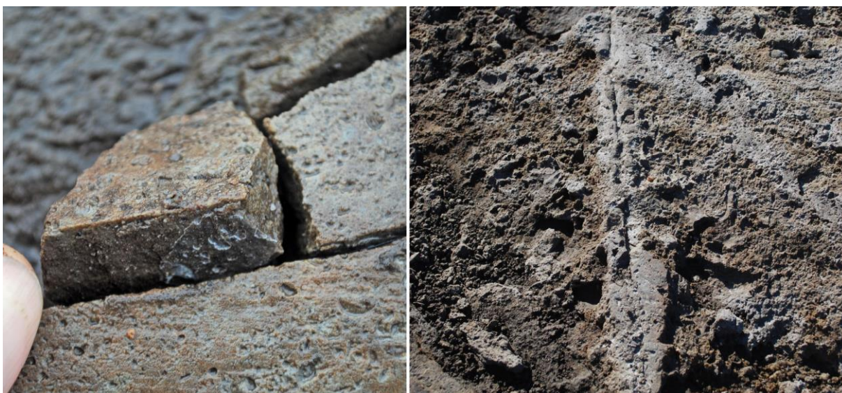
Figur 17: Hoppestad 2: Sprekk fylt med kvarts til venstre og tilsvarende til høyre, men her med silisifisering («kvartsforsterkning») innover i den her temmelig fossilrike sandsteinen. Merk at denne dannelsen av kvarts er helt lokal og ikke gjennomsettende i berget.
