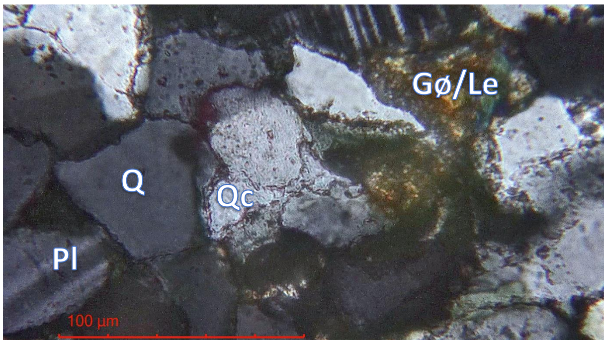
Figur 49: Forvitret del av prøve fra Nordbø. Kvartskorn (Q), plagioklaskorn (Pl) kvartsement (Qc). Karbonatsement er løst opp og leirmineraler og sannsynlig jern(hydr)oksid (Gø/Le) fyller deler av noen porer. XPL
