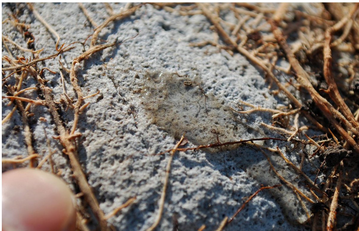
Figur 54: Test med fortynnet saltsyre på Ås 2. Dråpen blir liggende i mange minutter og det er ingen tegn til brusing fra karbonat, selv om vi vet at det er karbonat en cm eller to inn fra overflaten.
