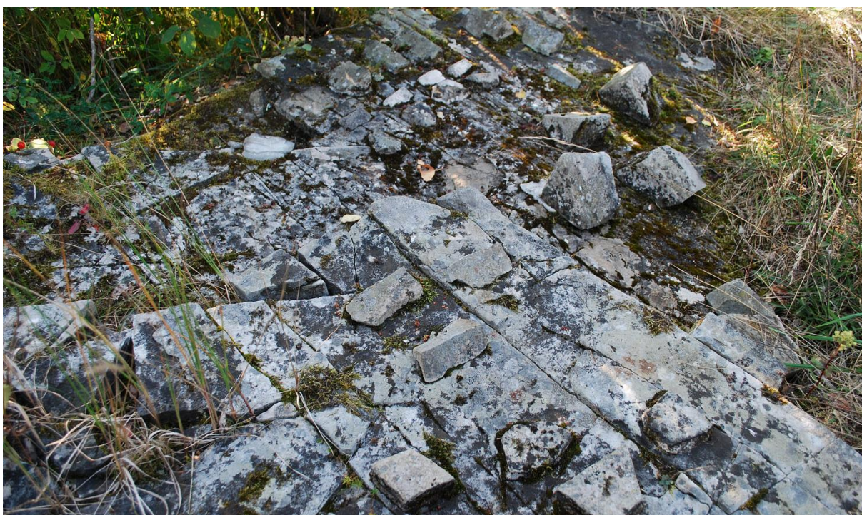
Figur 38: Testfelt for mørtel og lim ved Ås 3. Mange stein har løsnet og kommet ut av posisjon, andre holder fortsatt stand.
