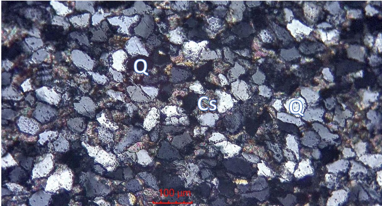
Figur 39: Frisk, finkornet, velsortert sandstein, med monokrystallin kvarts (Q). Karbonat (kalkspat) (Cs) er det synligste av sementene, men her er også kvartssement og leiresement. Ås 4, representativ også for Nordbø og Hoppestad 2. Polarisasjonsmikroskop, dobbelt polarisert lys (XPL)
