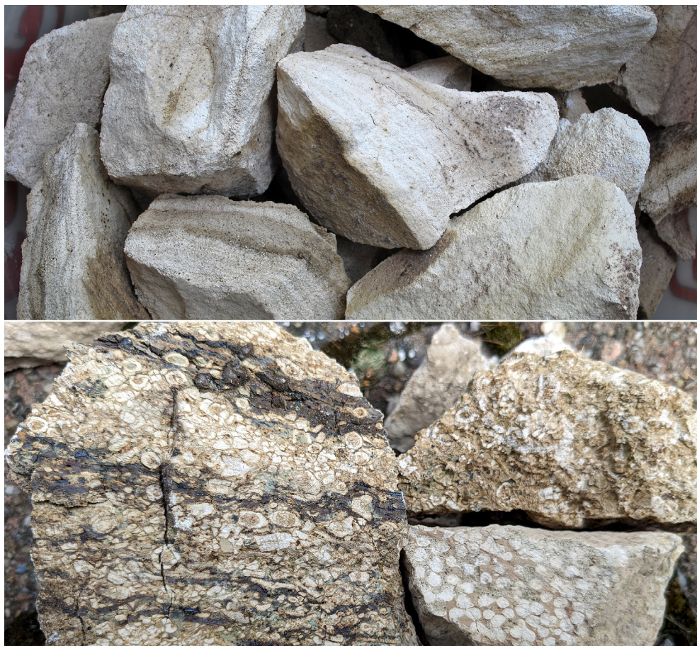
Figur 10: Forskjellen mellom stykkalk (brent kalk) brent fra temmelig ren marmor (over) og ganske uren kalkstein med masse fossiler (under). Her ser en brent Mostermarmor og brent kalkstein fra Grenland. Marmoren gir hvit, sub-hydraulisk mørtel, kun med en beige teint, kalksteinen en svakt til middels hydraulisk mørtel med svakt lysebrun farge.
