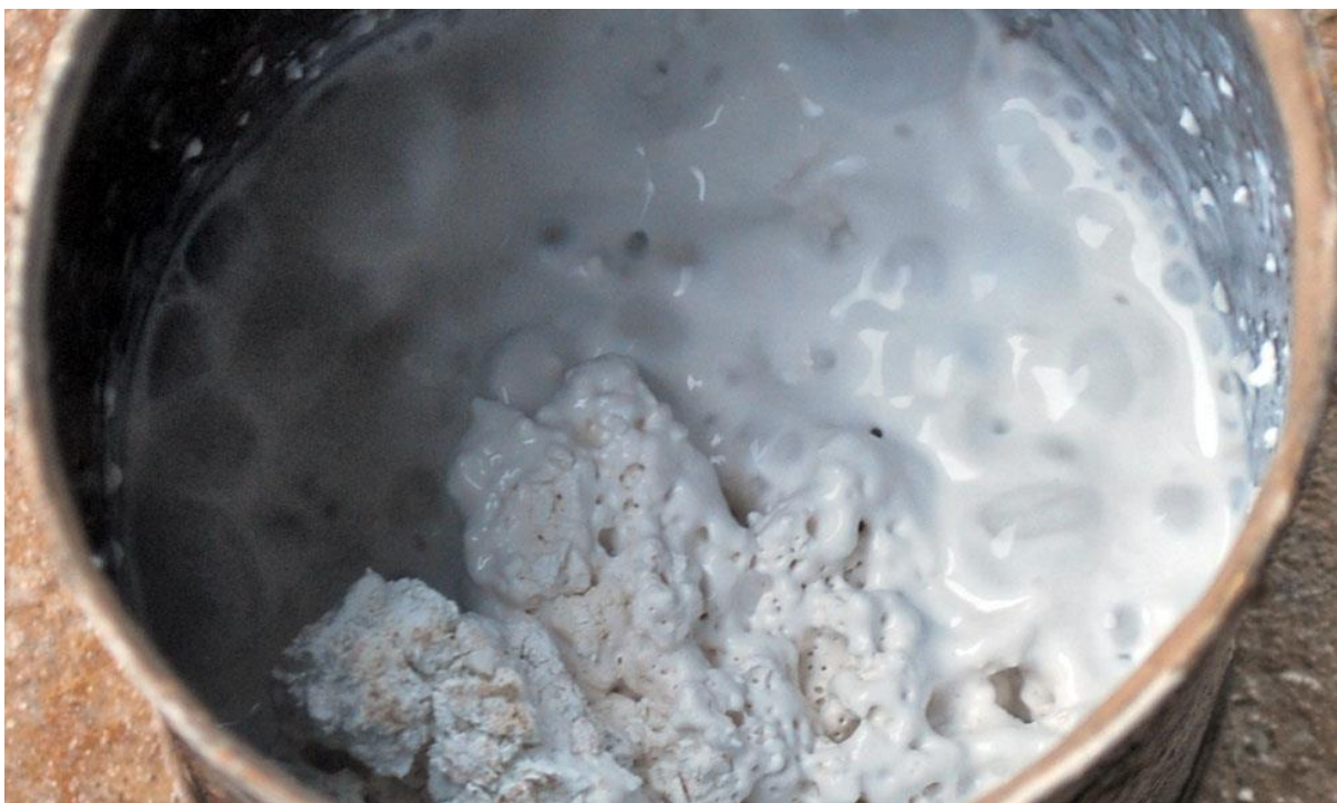
Boblende, kokende lesking av hvit Skaftåkalk. Kalken er nokså «eksplosiv» og leskes best når den er litt neddykket i vann.
