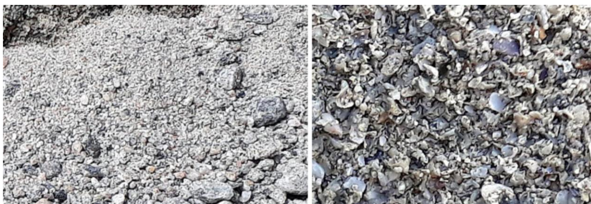
Inntrykk av sanden som ble brukt til å blande mørtel: Breelevsand fra Modalen (til venstre) og skjellsand fra Sotra. Maks. kornstørrelse er ca. 8 mm.
