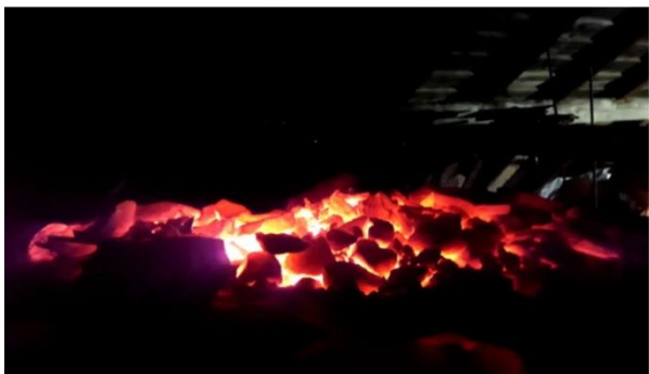
T.v. oppe: Slik ser ovnen ut på toppen under brenning: Pakket inn med steinplater og mørtel, med åpninger for trekk. Nede: Brenningen er over og topplokket er fjernet over en haug med glødende kalk. T.h: Ovnen brenner ut, med 20 glødende, nedfalte stein fra hvelvet.
