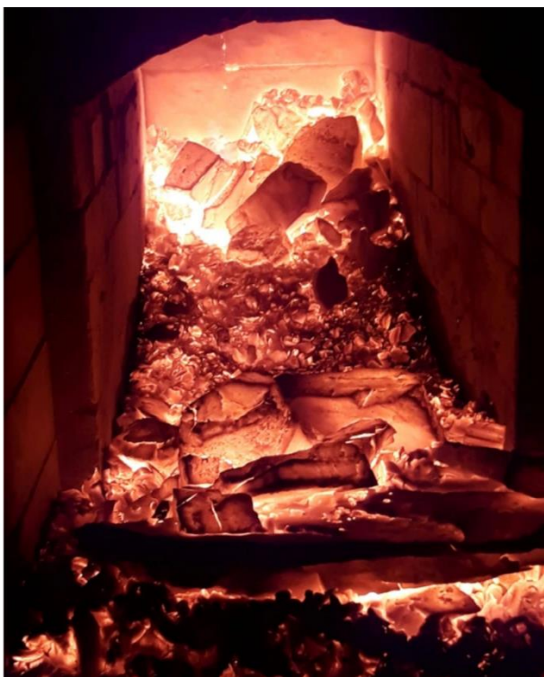
T.v. oppe: Slik ser ovnen ut på toppen under brenning: Pakket inn med steinplater og mørtel, med åpninger for trekk. Nede: Brenningen er over og topplokket er fjernet over en haug med glødende kalk. T.h: Ovnen brenner ut, med 20 glødende, nedfalte stein fra hvelvet.
