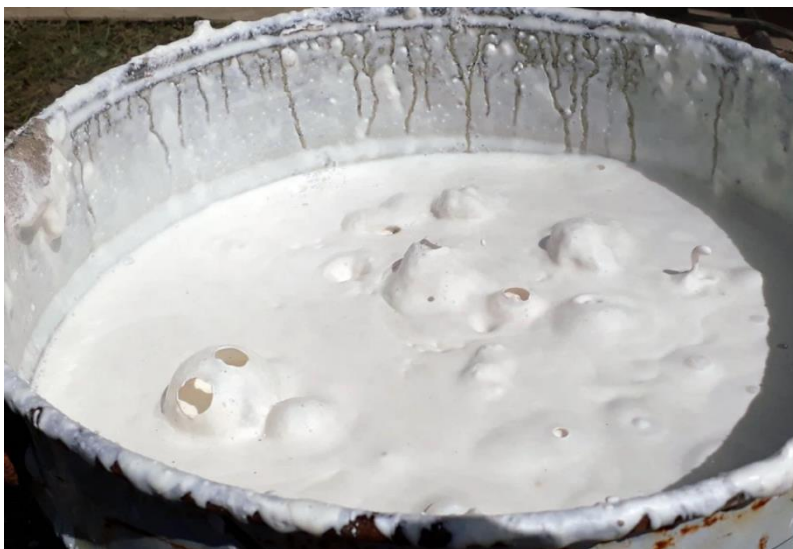
Det syder og koker ved våtlesking av Osterøykalk! Instruktør Tore Granmo blander våtlesket Osterøykalk med finsand
