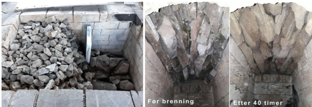
Utbytte fra den andre brenningen. Alt bak platen som er satt opp for illustrasjon er gjennombrent. Det som er foran hadde vi ikke tenkt å brenne, det var fylt med «skrotstein».
