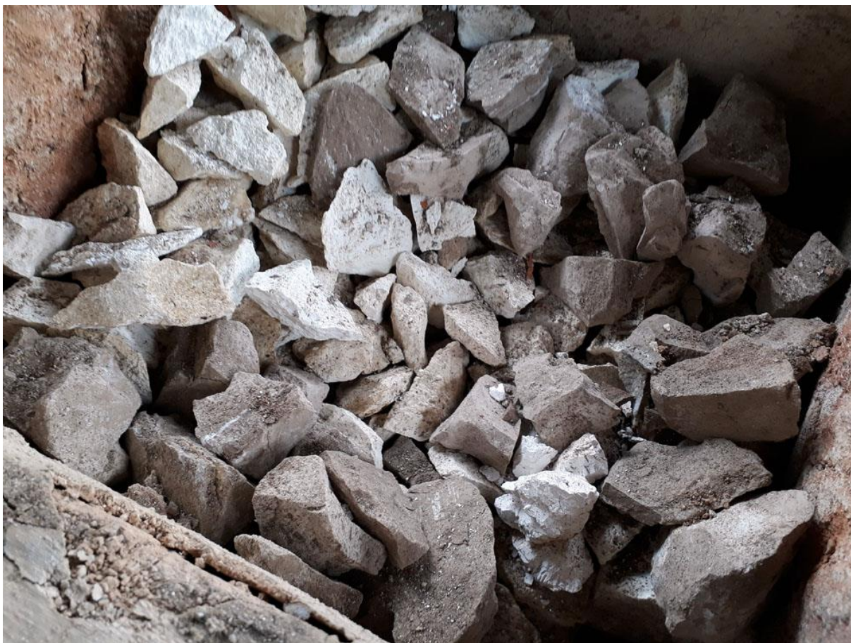
Blikk ned i toppen av ovnen ved uttak av den brente kalken. Vi la i for små biter, noe som begrenset trekken og økte brenntiden. Hvitt er Skaftåkalk, gråbrunlig Hyllestadkalk, som bare er lagt i helt på toppen.
