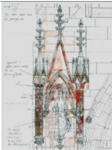
Feltkartlegging av skader på Xerox-kopier av feltoppmålingen
