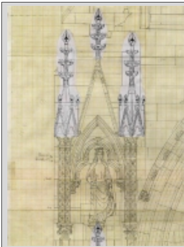
Feltoppmåling på millimeterpapir med fialtegningene fra 1920 limt på plass
