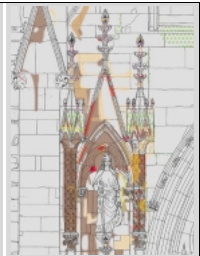
Ferdig kartprodukt (skader) digitalt rentegnet med Divisual®
