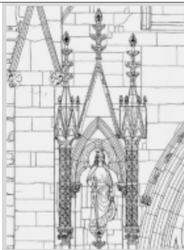
Ferdig oppmålingstegning laget med tusj på folie og senere scannet
