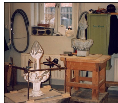
Ferdig modellert gipsfial (korsblomst). Formen blir overført til stein ved hjelp av punkteringsapparat
