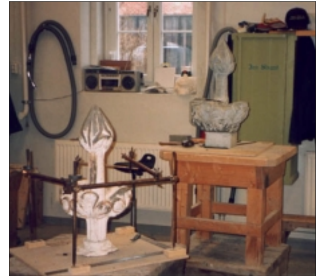
Ferdig modellert gipsfial. Formen blir overført til stein ved hjelp av punkteringsapparat
