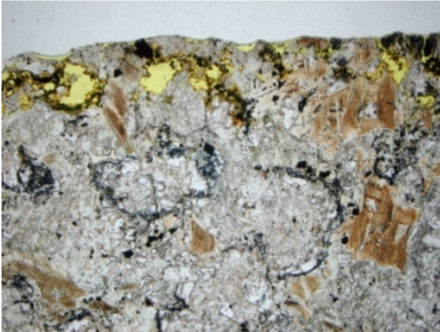
Spraglete kleber fra nedfalt bit på Østfronten (prøve SK 10). Normalt lys, bildebr. 2,2 mm
