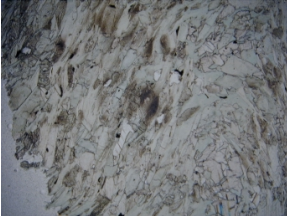
Prøve fra Ertenstein steinbrudd (ER1), normalt lys, bildebredde ca. 4,5 mm
